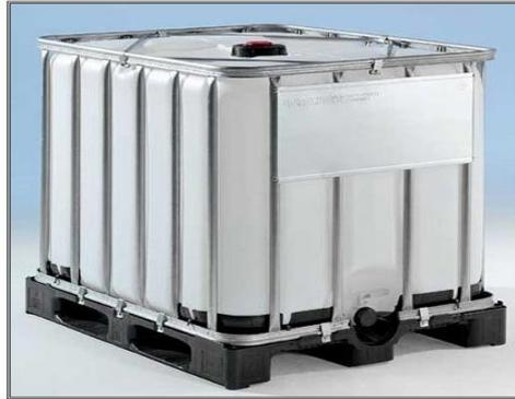
Estos depósitos son rígidos, llevan un tapón doble en la parte superior que nos permite introducir el tubo para llenarlo sin agujerearlo e incorporan un grifo de purga en la parte inferior. Por último, descansan sobre un palet de plástico al que se encuentran anclados mediante una estructura metálica que los cubre: no será necesario por lo tanto realizar soleras para su colocación, son resistentes y fáciles de transportar.
